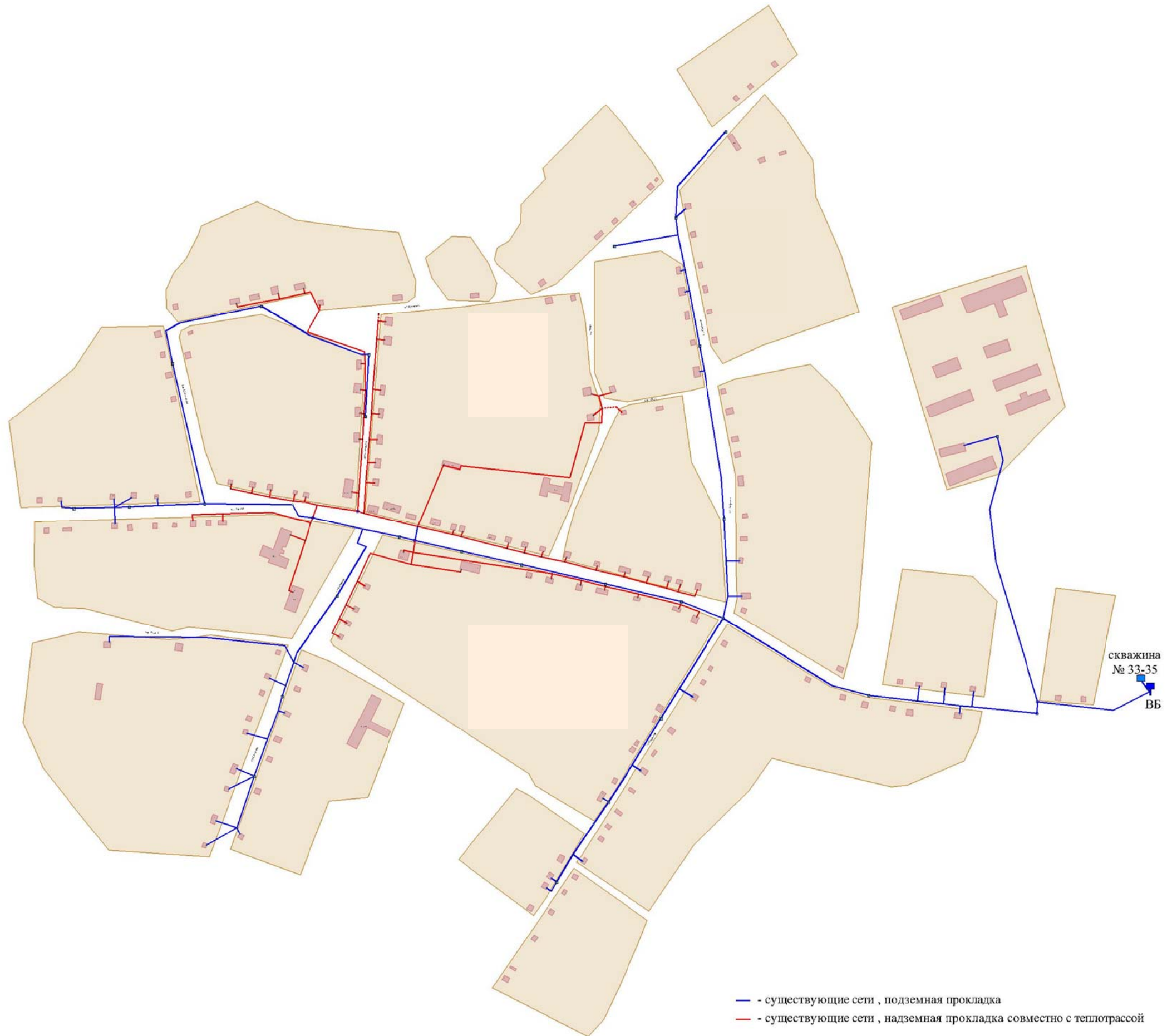
Рисунок 5.3 – Схема существующего размещения объектов централизованной системы водоснабжения
