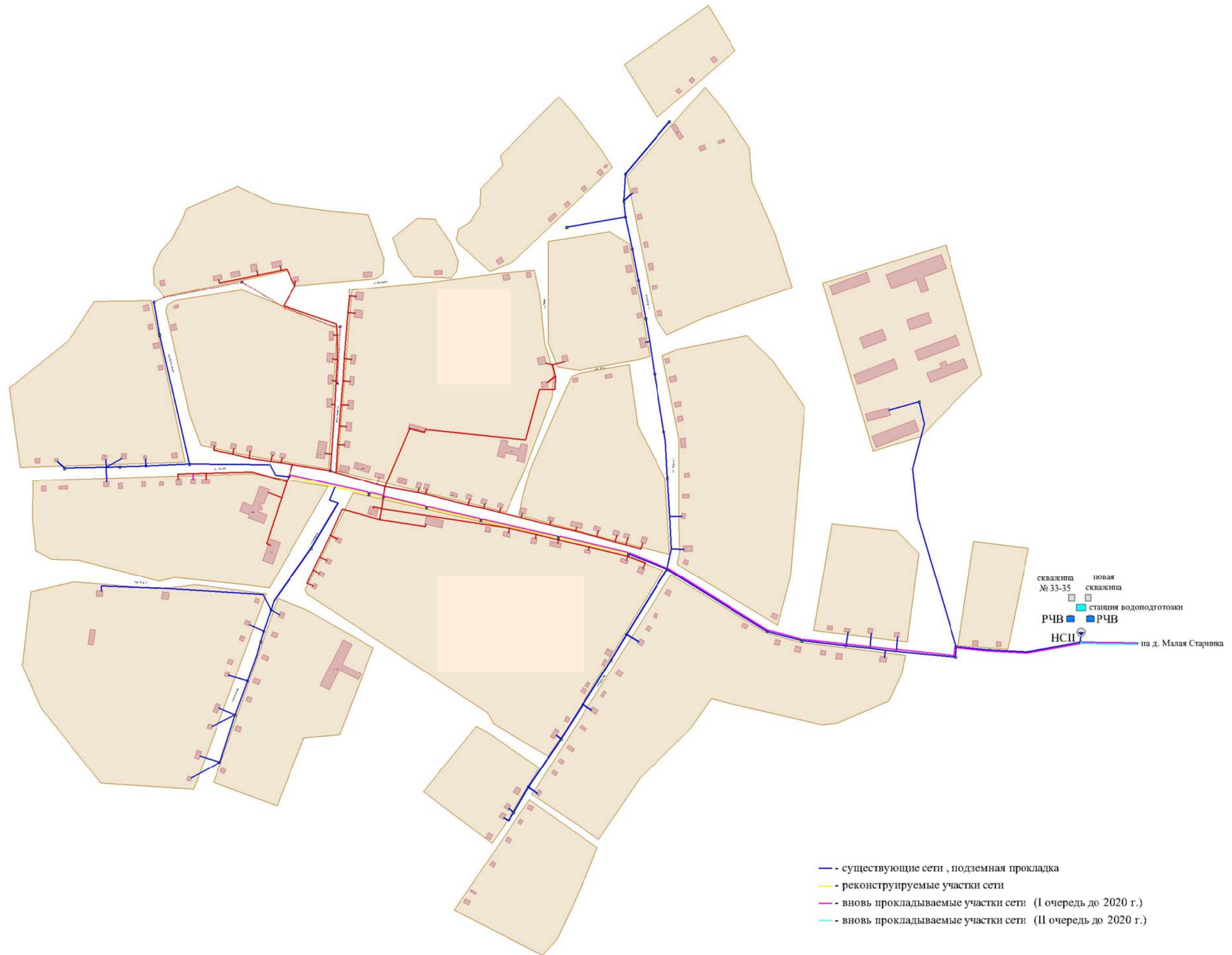
Рисунок 5.4 – Схема планируемого размещения объектов централизованной системы водоснабжения до 2020 г.
